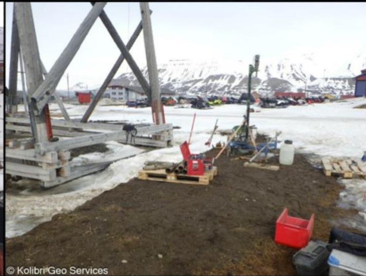
Figur 3: Borehull utført i vår 2023 (23–30.05.2023) med PermaRICH budsjetts ved a) Taubanesentralen og b) Bukk 6 (line 5-6) i Longyearbyen. Målingsensorer (termistorstreng) har vært installert i høst 2023. Analysen av borekjernene (grunnstratigrafiundersøkelse) skal utføres i løpet av vinter 2023–2024.
